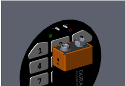
Bild 2. Kontakte zur Notbestromung
